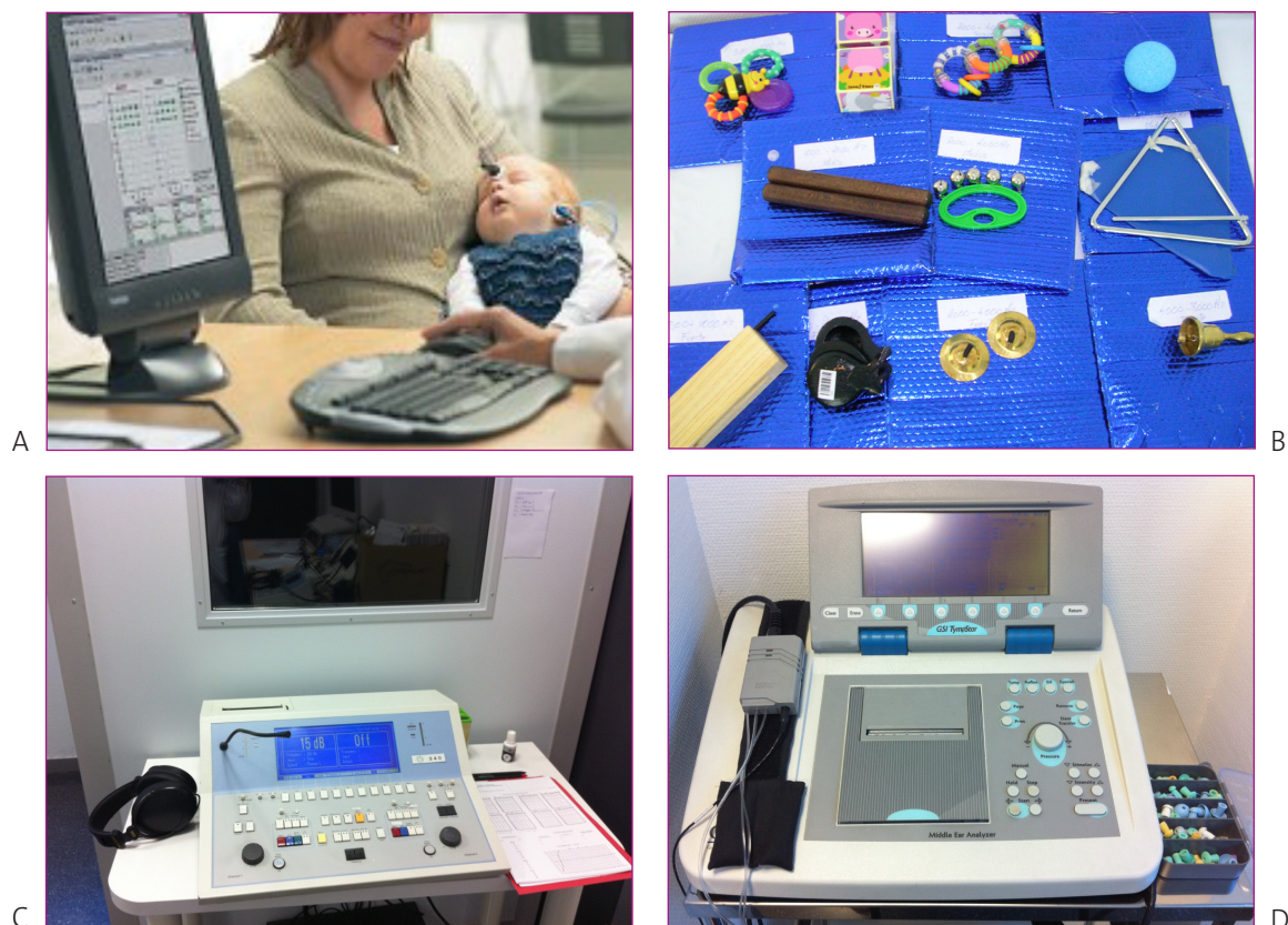
Figura 1. Principales aparatos disponibles para la evaluación auditiva: A. Potenciales evocados auditivos. B. Juguetes sonoros. C. Audiómetro. D. Impedancímetro
